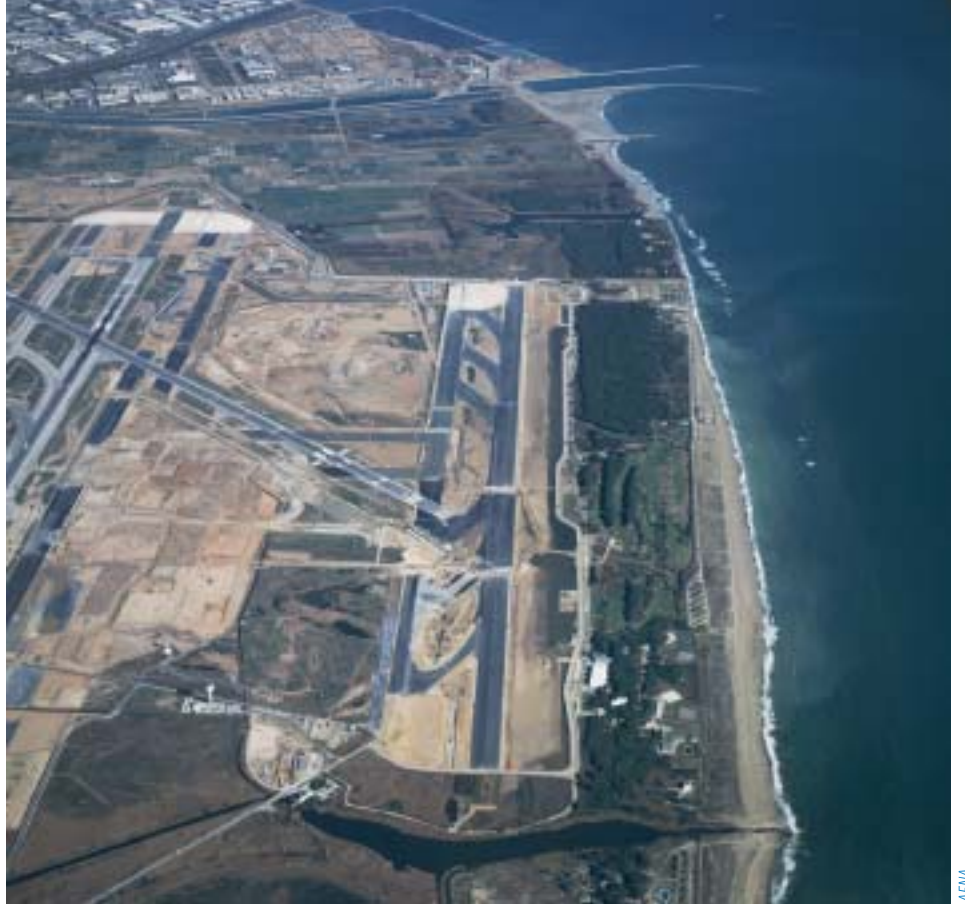
Imagen aérea reciente, en la que ya se aprecia perfectamente la tercera pista, paralela a la playa y situada entre las lagunas del Remolar (parte baja de la foto) y la de la Ricarda. En la parte superior de la imagen también se aprecian los dos cauces del Llobregat: el actual y el del futuro desvío.
